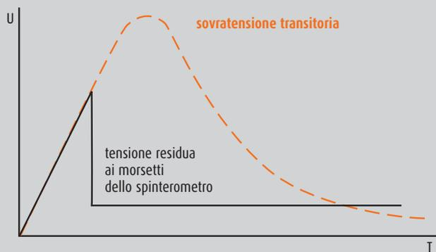
Variazione della tensione in funzione della corrente ai morsetti dello spinterometro
