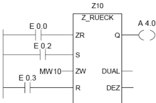
Un cambiamento dello stato di segnale da "0" a "1" all'ingresso E 0.2 setta il contatore con il valore di MW10. Se lo stato di segnale di E 0.0 cambia da "0" a "1", il valore del contatore Z10 viene decrementato di "1", eccetto quando il valore di Z10 è uguale a "0". A 4.0 è "1", se Z10 è diverso da zero.
