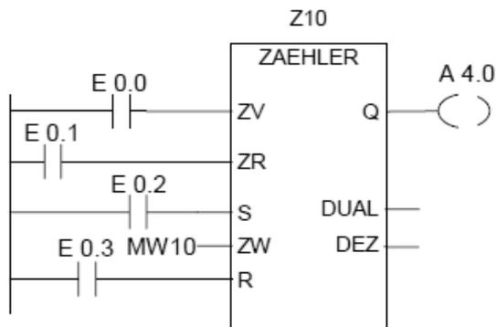
Con un cambiamento dello stato di segnale da "0" a "1" all'ingresso E 0.2, il contatore viene preimpostato con il valore di MW10. Se lo stato di segnale di E 0.0 cambia da "0" a "1", il valore del contatore Z10 viene incrementato di "1", eccetto quando il valore di Z10 è uguale a "999". Se E 0.1 cambia da "0" a "1", Z10 viene decrementato di "1", eccetto quando il valore di Z10 è uguale a zero. A 4.0 è "1", se Z10 è diverso da zero.
