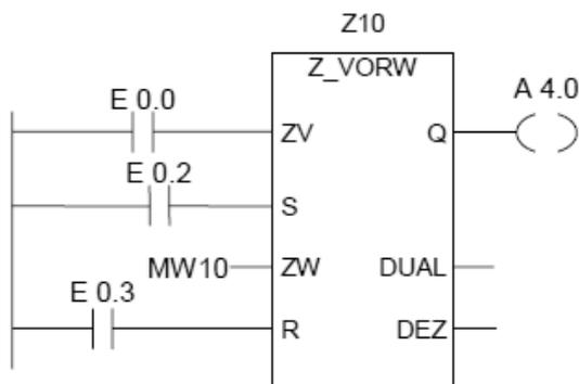
Con un cambiamento dello stato di segnale da "0" a "1" all'ingresso E 0.2, il contatore viene preimpostato con il valore di MW10. Se lo stato di segnale di E 0.0 cambia da "0" a "1", il valore del contatore Z10 viene incrementato di "1", eccetto quando il valore di Z10 è uguale a "999". A 4.0 è "1", se Z10 è diverso da zero.
