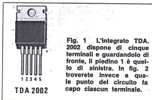
**Fig. 1** L'integrato TDA.2002 dispone di cinque terminali e guardandolo di fronte, il piedino 1 è quello di sinistra. In fig. 2 troverete invece a quale punto del circuito fa capo ciascun terminale.
