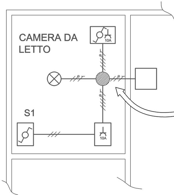
Iniziare la realizzazione dell' impianto della stanza da questa scatola di derivazione. Fase, neutro e terra partono da qui. Proseguire seguendo lo schema qui sotto e mantenendo la disposizione degli apparecchi come in pianta.
