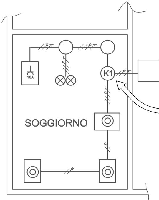
Iniziare la realizzazione dell' impianto della stanza da questa scatola di derivazione. Fase, neutro e terra partono da qui. Proseguire seguendo lo schema qui sotto e mantenendo la disposizione degli apparecchi come in pianta.
